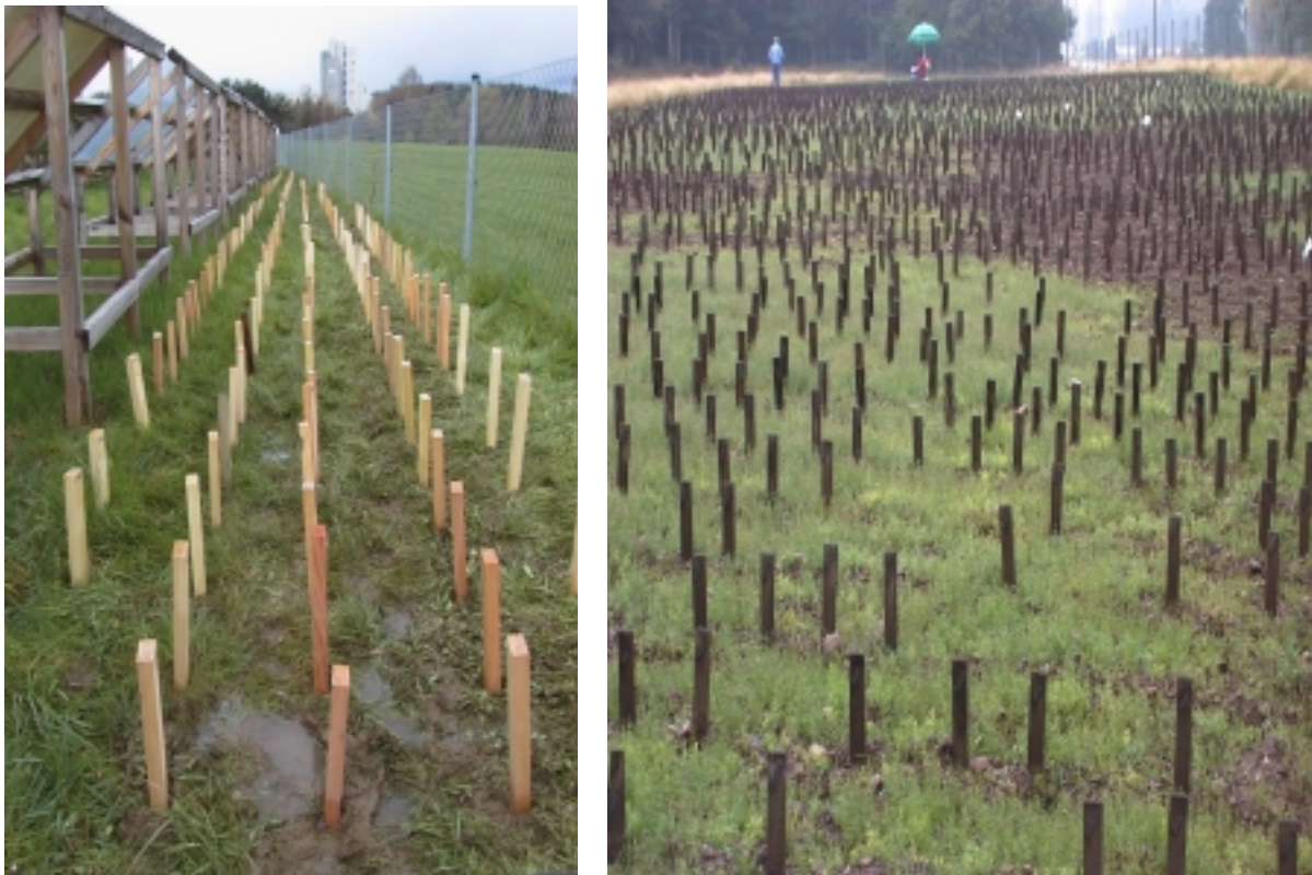
Abbildung 1: Prüfung der Dauerhaftigkeit nach EN 252 im Erdkontakt
