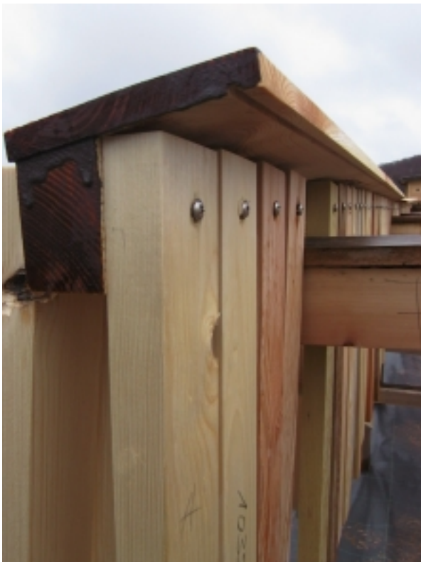
Abbildung 6: Prüfung der Dauerhaftigkeit in Gefährdungsklasse 3, hier vertikal geschützt mit Hirnholzabdeckung
