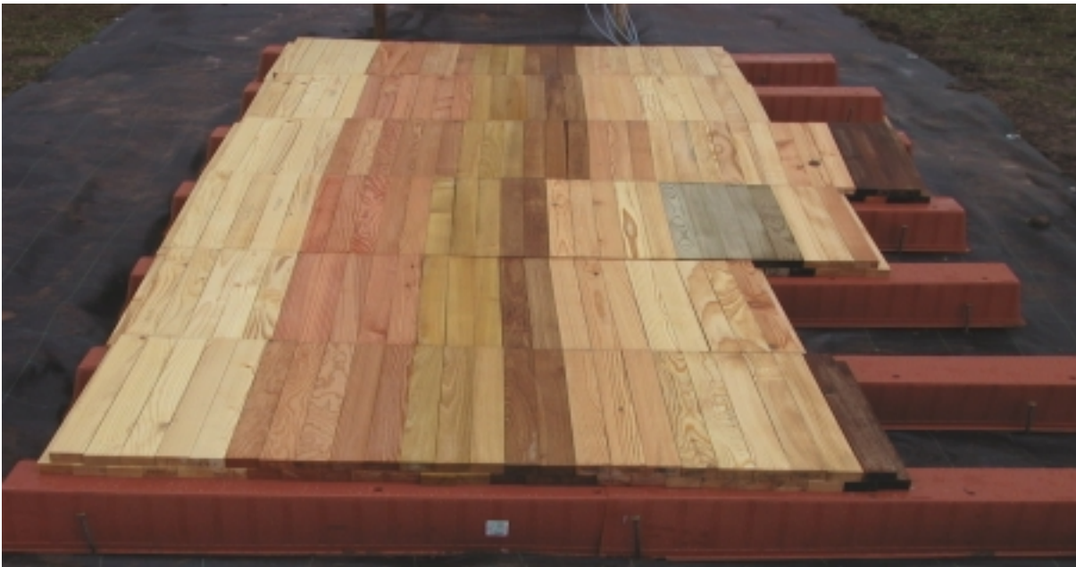
Abbildung 8: Prüfung der Dauerhaftigkeit in GK3, horizontale Exposition mit Kapillarlugen
